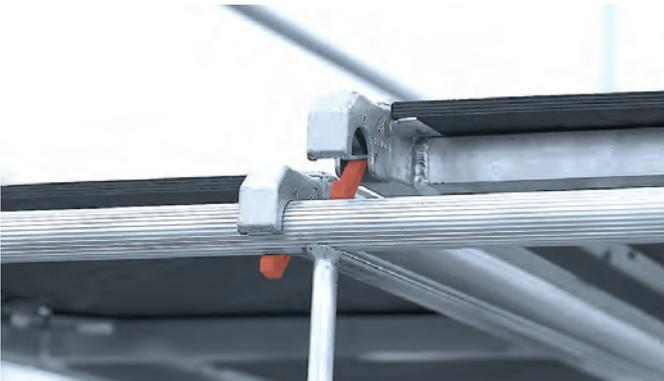
Der clevere Helfer bei der Demontage. Der Rapidverschluss an der Alu-Rahmentafel lässt sich auf der Sprosse auflegen, ohne selbsttätig wieder einzurasten. So können die Rahmentafeln von nur einem Mann ein- und ausgehängt werden.
