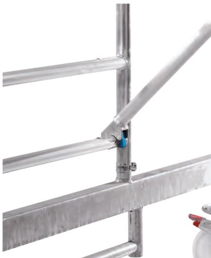
◀ Der Rapidverschluss aus Alu-Kokillen bzw. Alu-Druckguss – bei Belägen, Riegeln und Diagonalen. Mit federunterstütztem Schließbügel aus schlagfestem Polyamid mit Stahleinlage. Die farblichen Bügel ermöglichen die einfache Unterscheidung zwischen Längsriegeln und Diagonalen – ohne zu messen. Die als Innenaufstieg dienenden Sprossen der Vertikalrahmen sind rutsicher profiliert.
